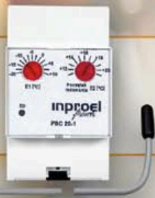
PSC 20 Sterowanie automatyczne ładowania z zewnętrzną sondą pogodową. Max moc 300 W. Możliwość sterowania max 18 piecami.
